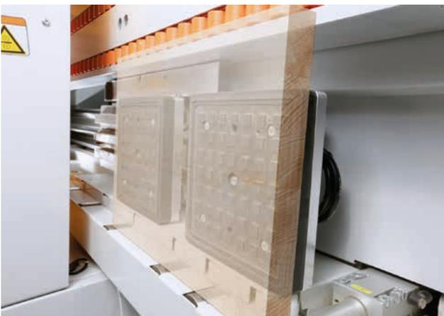
▲ Auch die Fräsungen für verschiedene Verbindter können auf allen vier Kanten sowie in X- und Y-Richtung ausgeführt werden
