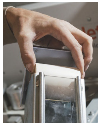
Ulrich Palsmeier legt eine PUR-Kartusche in den Schacht der Glu-Jet-Einheit
