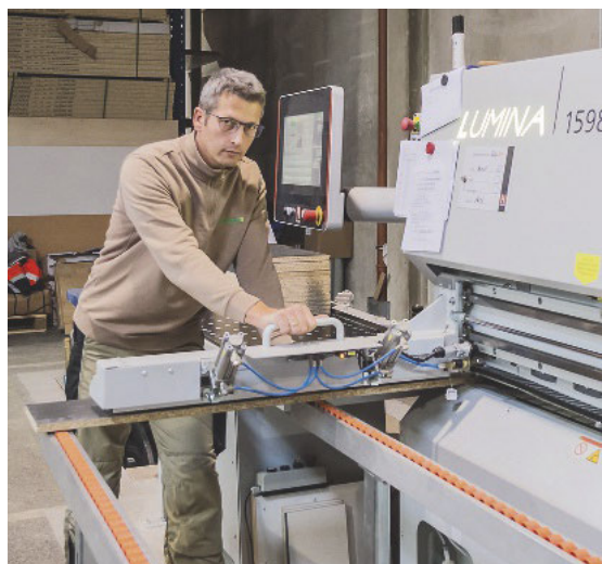
Ein Schiebeschlitten mit Hubanschlag stellt bei schmalen Werkstücken rechte Winkel sicher
